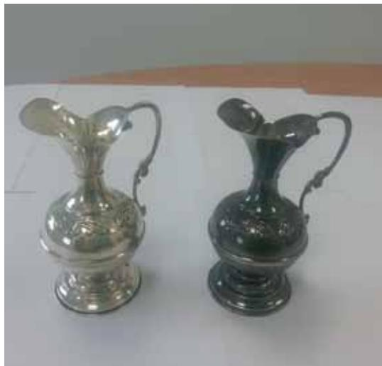
Esempio di processo messo a punto da Plasmapps per la pulizia e la protezione dalla corrosione dei metalli: nell'immagine a sinistra un'anfora di argento trattata al plasma (ripulita e rivestita con coating protettivo) e a destra un'anfora non trattata ed ossidata. [www.plasmapps.com](http://www.plasmapps.com)
